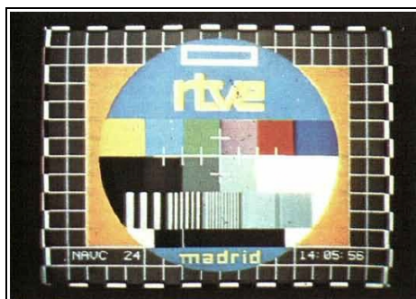
La mire de la TVE à Madrid en 1976 au standard couleur PAL qui permettait de régler et d'étalonner son affichage avec des valeurs uniformisées 413 . Source : RTVE 1976. Nuestro libro del año .
