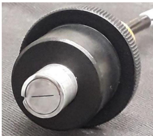
Figure 2-2 : Photo du bundle de fibres optiques.
