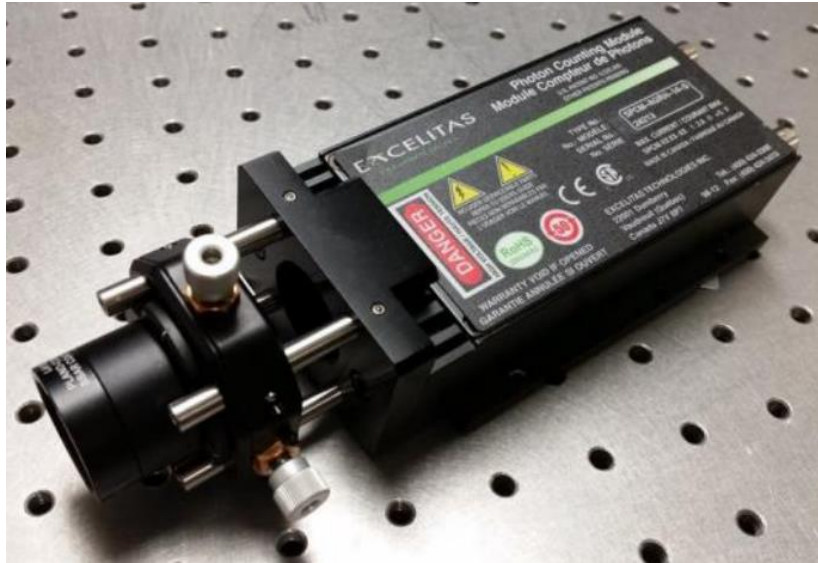
Figure 5-3 : Photo du détecteur TCSPC SPCM-AQRH utilisé sur notre montage. Un ensemble d'éléments du système de cage 30 mm de chez Thorlabs est fixé à l'avant du module.
