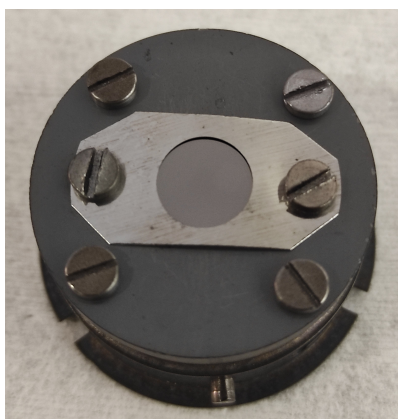
Figure 2.22 – Porte-échantillon utilisé dans la chambre d'analyse in situ
