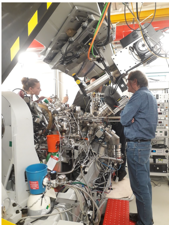
Figure 2.29 – Photographie du bâti de DRX in situ de la ligne SIXS de SOLEIL
