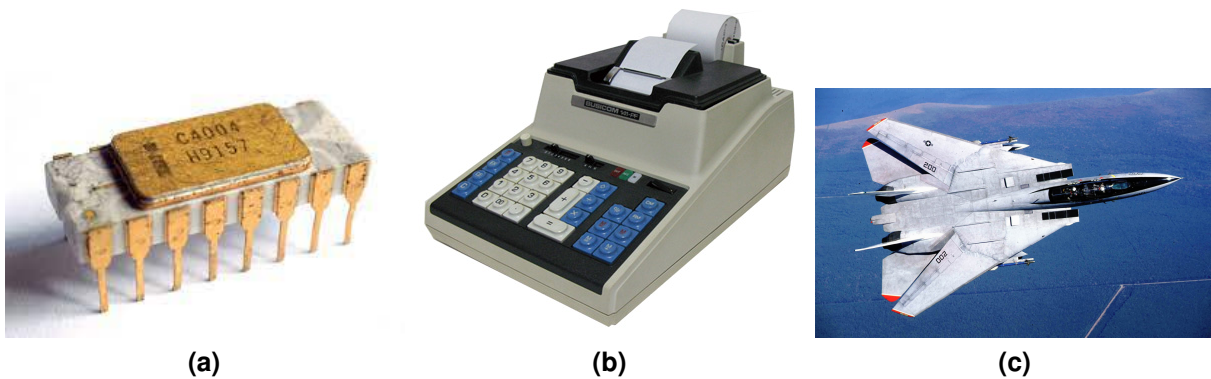
Figure 1.1: Le premier microprocesseur et des exemples de son utilisation : (a) Intel c4004 [8]. (b) Busicom 141-PF [9]. (c) L'avion de chasse F-14 Tomcat [10].
