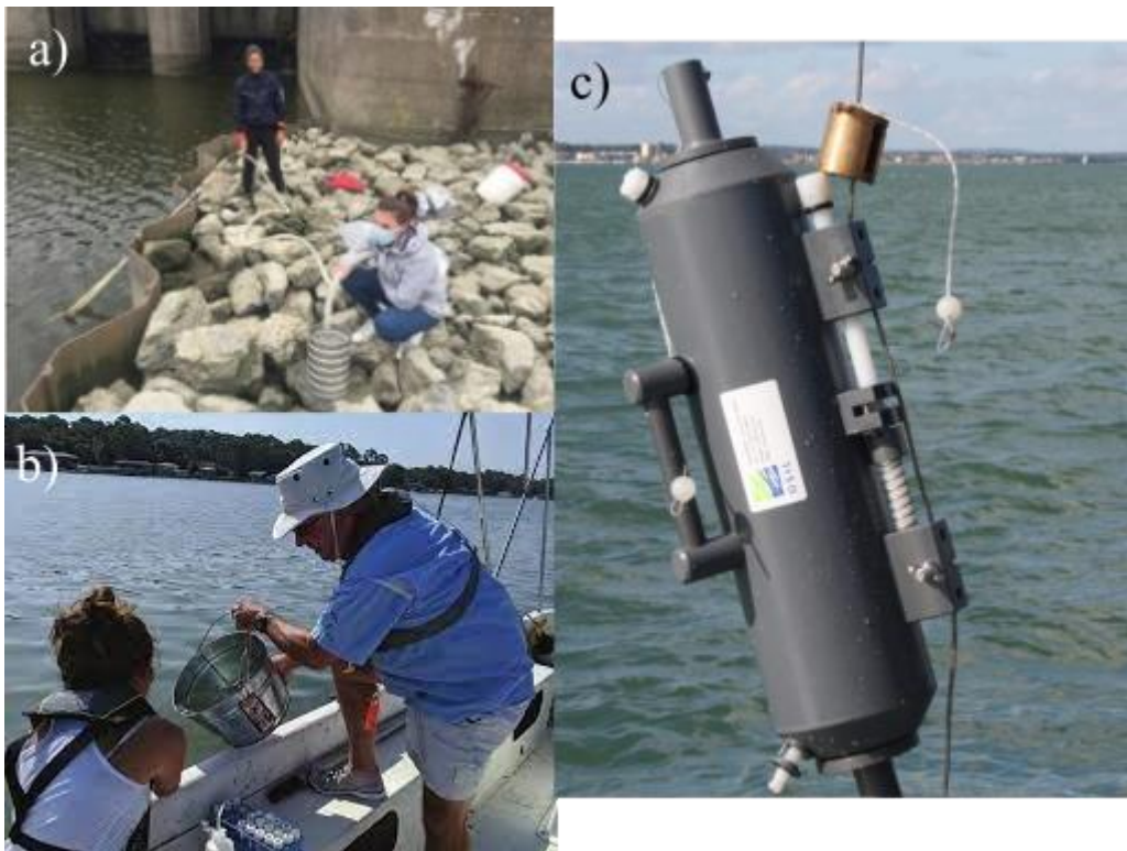
Figure 6 : Exemples de méthodes à petits volumes : a) la pompe in-situ b) l'échantillonnage au seau et c) la bouteille Niskin. Photo de la bouteille Niskin prise du site « osil.com »
