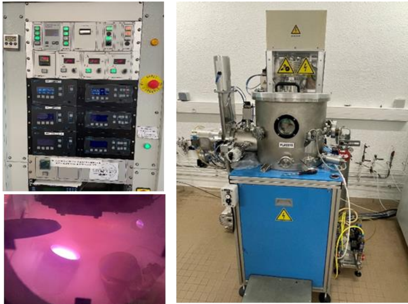
Figure 34: Photographie de l'extérieur et de l'intérieur du réacteur de dépôt et de l'armoire de pilotage associée.
