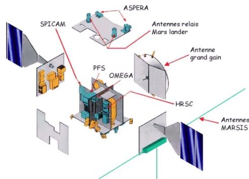
Figure 1.9. Vue éclatée des instruments à bord de MEX (crédit : CNES)
