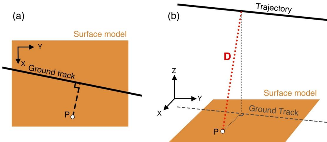
Figure 2.19. Schéma décrivant la géométrie de la projection de données radar sur un modèle de forme.
