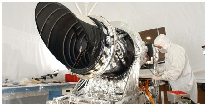
Figure 4.16. L’instrument HiRISE lors de la phase d’assemblage ([mars.nasa.gov/mro/mission/instruments/hirise/](https://mars.nasa.gov/mro/mission/instruments/hirise/)).
