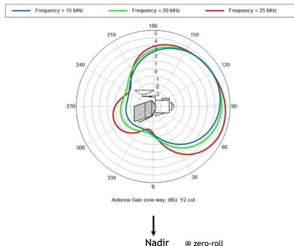
Figure 4.1. Diagramme d'émission de l'antenne de SHARAD à 15, 20 et 25 MHz. On remarque que dans la direction de sondage (à 0° sur le diagramme), le gain de l'antenne est à -1dBi, contre 4dBi au maximum à 120°.
