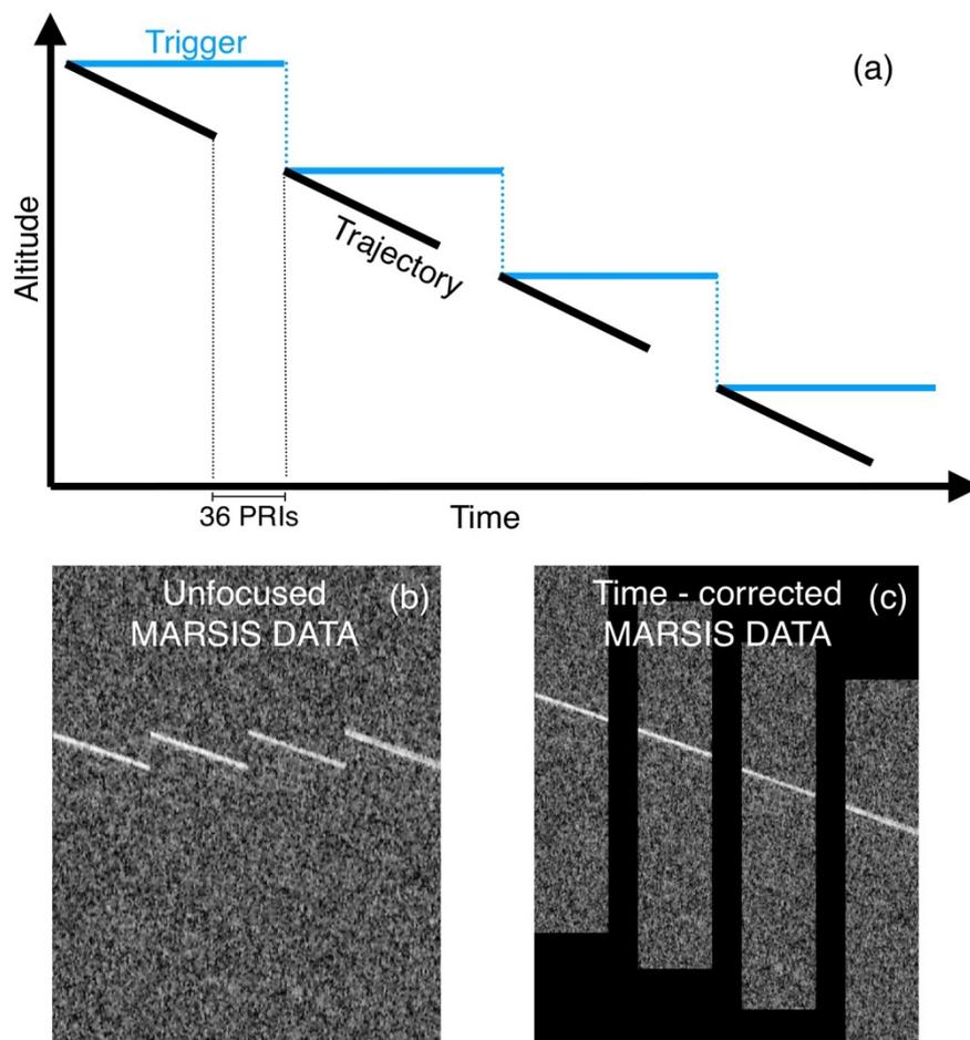
Figure 6.14. Illustration du mode de mesure pour les orbites avec une forte inclinaison. La durée entre les fenêtres d'émission et de réception (« Trigger ») est ajustée à intervalle régulier, et pendant une durée de 36 PRI (Pulse Repetition Intervals), aucune donnée n'est prise. Un extrait du jeu de données MARSIS n°04814 figure en (b), et sa version corrigée en temps court et temps long est visible en (c).
