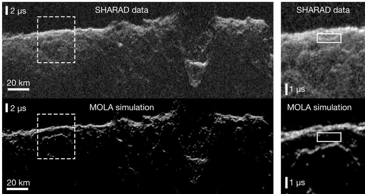
Figure 5.4. Comparaison entre le jeu de données SHARAD n°5128501 et la simulation correspondante avec un modèle de terrain MOLA (463m). Le zoom sur la droite de la figure correspond au rectangle pointillé sur la partie gauche. Le rectangle blanc sur la droite correspond à la position du réflecteur identifié par Adeli et al. (2019).
