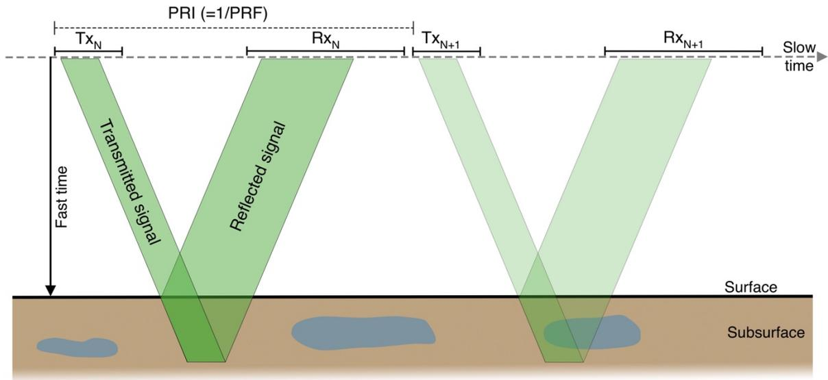
Figure 2.1. Schéma de fonctionnement du sondage radar.
