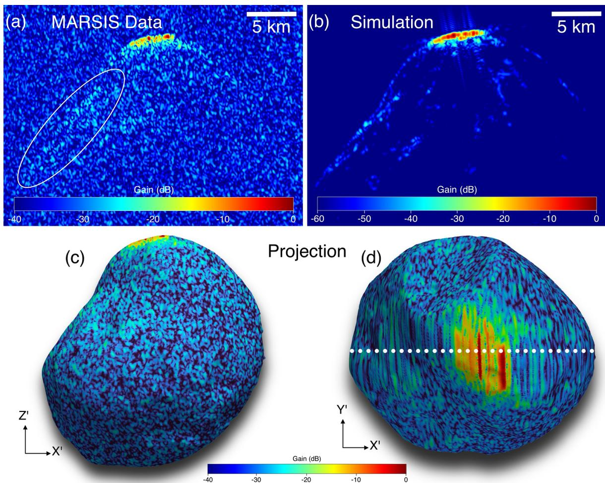
Figure 6.11 (a) : Jeu de données MARSIS n°20041. (b) : Simulation avec le modèle de Ernst *et al.* (2023). (c) : Projection des données MARSIS sur le modèle, avec une vue normale au plan de synthèse. On distingue le contour de Phobos, aussi visible sur les données MARSIS. (d) : Projection vue du point de vue de MARSIS.
