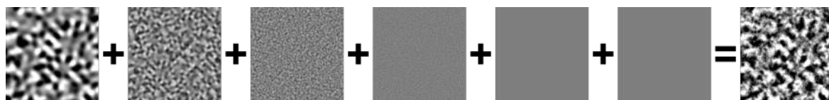
FIGURE 2.30 – Le bruit fractal (à droite) est composé d'une somme de réalisations d'un même bruit à des fréquences croissantes et des amplitudes décroissantes.
