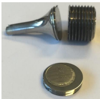
Figure 81 : Pastille découpée dans la tête d'une éprouvette pour caractériser la précipitation \gamma' .
