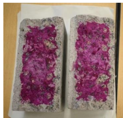
Figure 3-2 : Photo montrant la profondeur de carbonatation d'une éprouvette 15×15×7 cm 3 ayant subi la cure à 65% HR, 20°C et 3% CO 2 .
