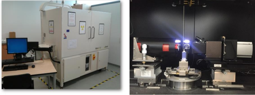
Figure 2-12 : Micro-tomographe à rayons X (à gauche) et (à droite) détails de l'intérieur (caméra, porte échantillon).
