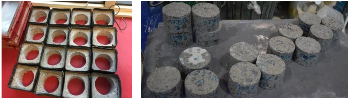
Figure 3-22 : Photos montrant les carottages dans les éprouvettes testées au gel-dégel.
