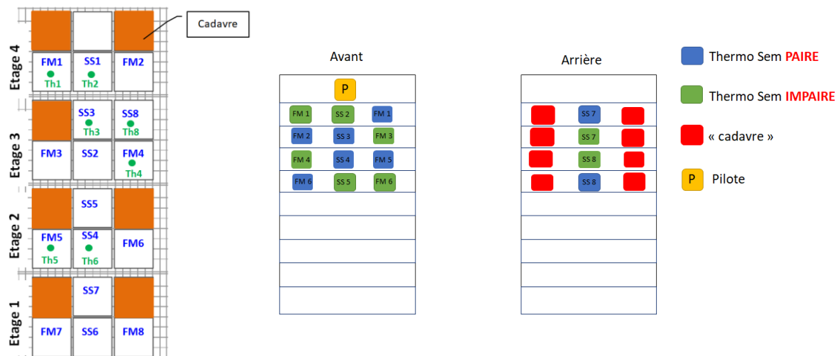
Figure viii-12: Schéma montrant l'arrangement des éprouvettes dans les enceintes des laboratoires impliqués, à gauche, GeM, Holcim et TFB et à droite SigmaBéton.
