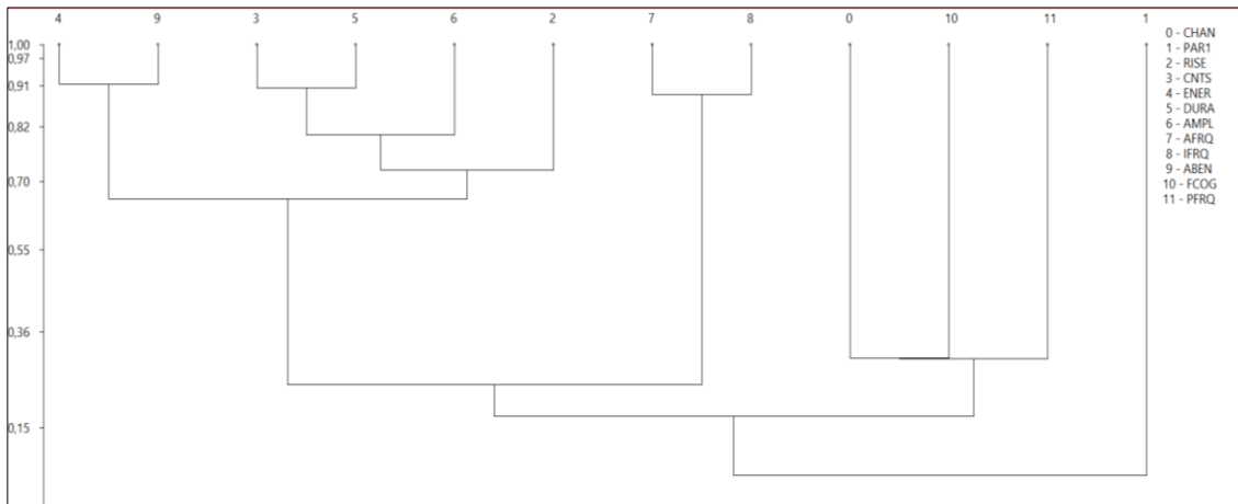
Figure 5-20 : Dendrogramme de corrélation entre les caractéristiques des signaux d'EA.
