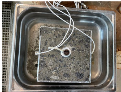
Figure 5-18 : Montage des capteurs d'EA sur l'éprouvette de béton exposée au gel-dégel.
