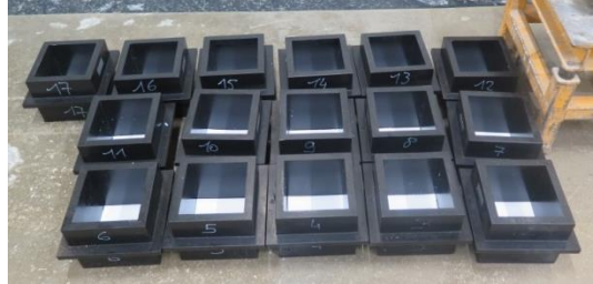
Figure viii-10 : Photo des moules en PVC utilisés dans l'essai d'inter-comparaisons.
