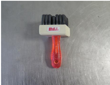
Figure 2-9 : Brosse TFB utilisée pour collecter les écaïlles des surfaces d'essai.
