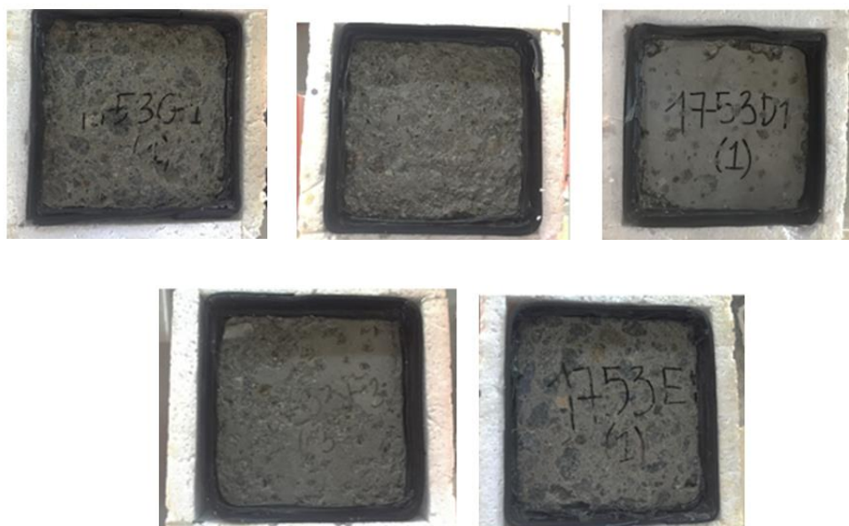
Figure 3-17: Surfaces dégradées des éprouvettes de béton (S1-S5) après 56 cycles de gel-dégel de [+20/-20°C].
