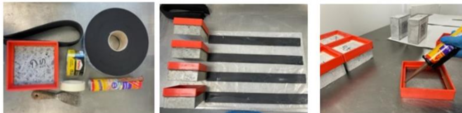
Figure 5-13 : Photos montrant le montage des cadres SIA.
