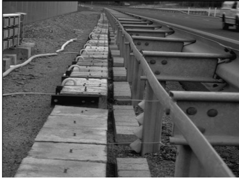
Figure 1-11 : Localisation d'échantillons de 150 x 150 x 70 mm 3 sur le site (à gauche) et une photo du site en un jour hivernal [71].
