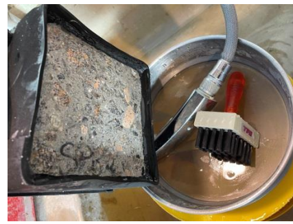
Figure 2-10 : Positionnement de l'éprouvette pour récupérer les écaïlles.
