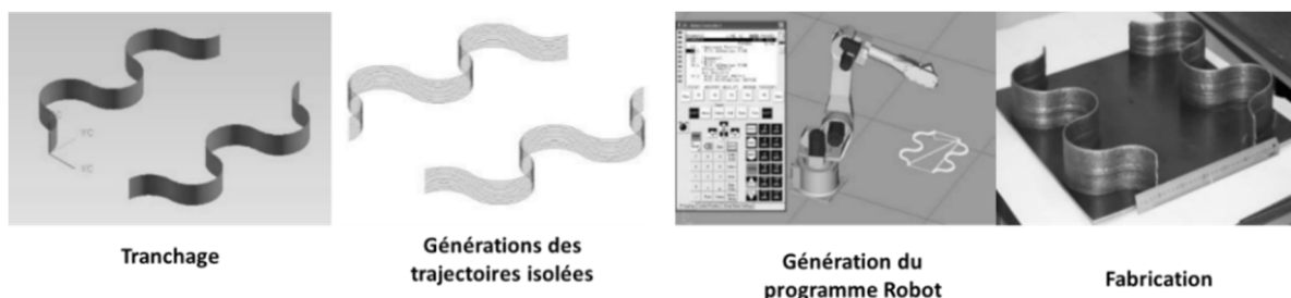
Figure 1.21 : Planification des trajectoires avec RUAMROB [Mehnen et al. 2011]
