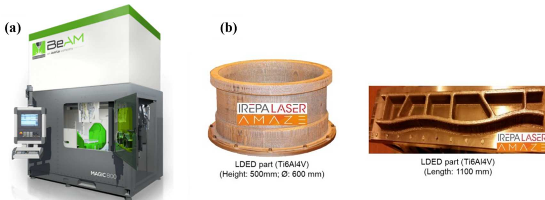
Figure 1.4 : Machine cartésienne MAGIC 800 (a), Pièces métalliques réalisées [Nain 2022] (b)
