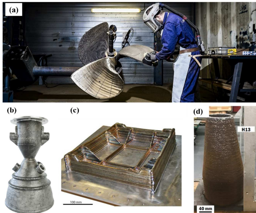
Figure 1.1 : WAAMPeller Hélice de navire de 1,35 m de diamètres, 400 kg fabriquée par le RAMLAB [RAMLAB, 2017] (a), Propulseur de fusée (400x236.5x236.5 mm) avec fonctionnalités supplémentaires fabriqué par MX3D (b), Caisson utilisé dans le train d'atterrissage (c), Pièce métallique fabriquée en DED [Ahn, 2021]
