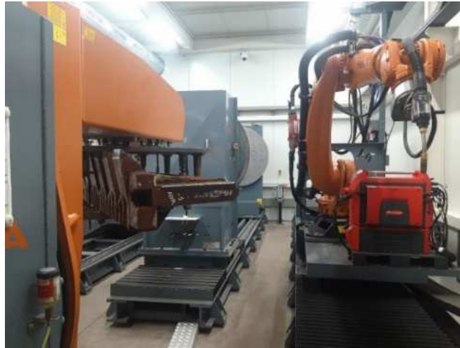
Figure 1.8 : Cellule de FAM WAAM sur le site d'ArcelorMittal [Guaranteed, 2020]
