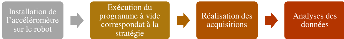
Figure 5.1 : Procédure de validation de la stratégie de fabrication avec l'accéléromètre.
