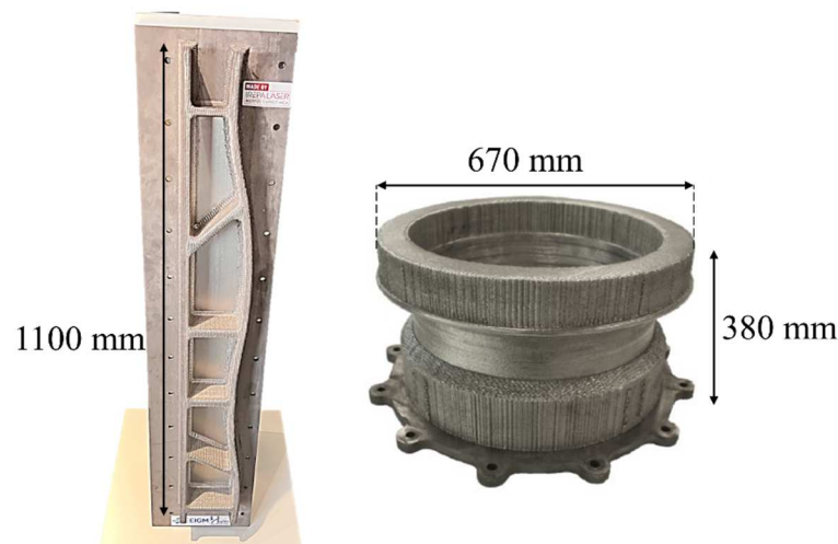
Figure 1.23 : Pièces réalisées par IREPA LASER en DED CLAD laser-poudre avec une machine à commande numérique
