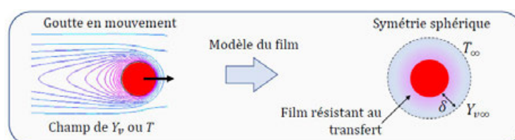
Fig. III.1-14 : Représentation de l'évaporation d'une goutte en mouvement © G.Castanet
