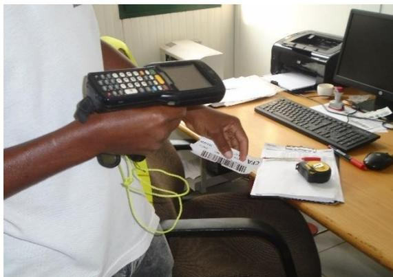
*Le nomade : Appareil utilisé pour vérifier la traçabilité du bois*
