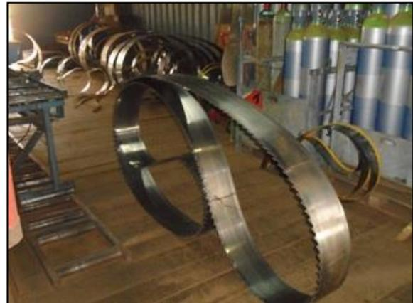
Sur les images, le métier d'affuteur à l'usine Somivab (Essassa) et les différents produits issus de ce dernier (des lames utilisées pour les machines à scier). Ce domaine est encore l'apanage de ressortissant étrangers. Une formation « sur le tas » permet cependant aux Gabonais d'acquérir de nouvelles compétences dans ce domaine.
