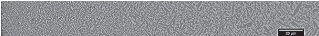
Figure VI-2 : Evolution de la microstructure en proche surface pour l'échantillon vieilli à 700°C pendant 5000h
