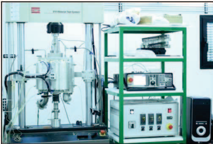
Figure II-18 : Photographie de la machine d'essai équipée d'un four à lampe
