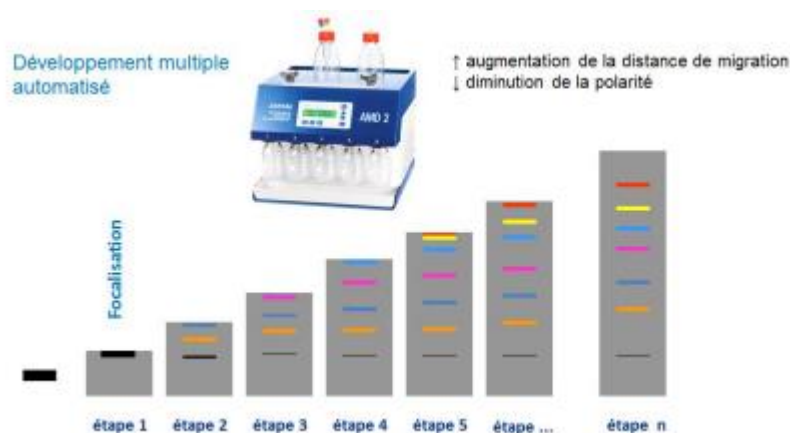
Figure 28: Fonctionnement du développement multiple automatisé (AMD)
