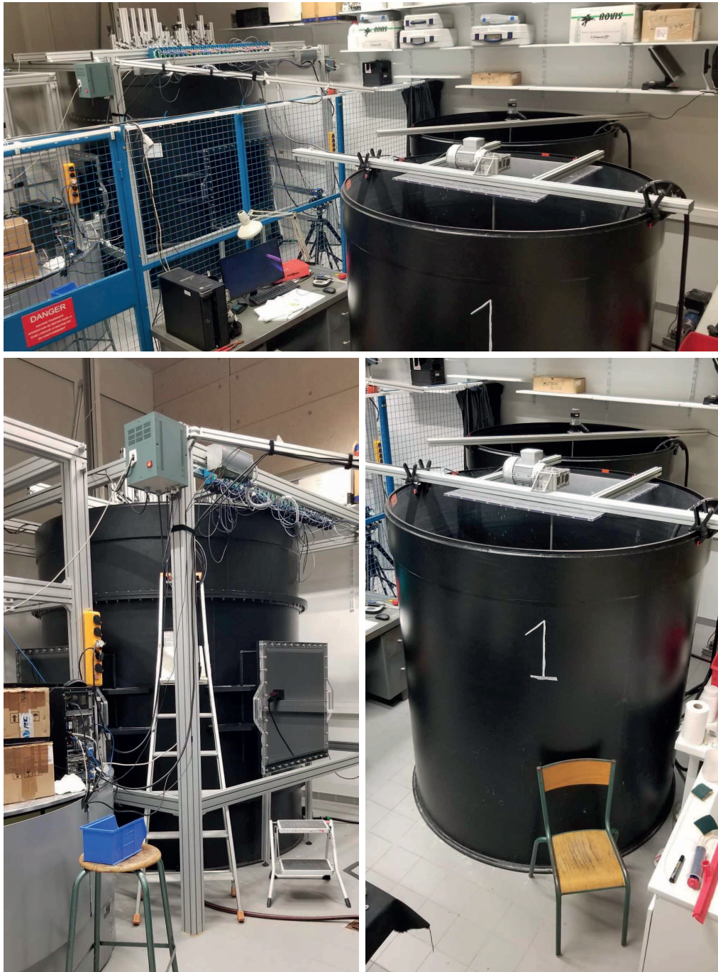
FIGURE 3.28 – Photos de notre nouveau dispositif expérimental. Sur la photo du haut, on montre une vue d’ensemble de notre salle. Sur la photo en bas à gauche, on voit notre cuve expérimentale. On remarque la structure métallique l’entourant et les deux hublots permettant d’observer l’écoulement. Sur la photo en bas à droite, on voit les cuves utilisées pour produire la stratification, la cuve 2 étant située derrière la cuve 1. On rappelle que la cuve expérimentale et les cuves de stratification mesurent respectivement 2,5 m et 1,85 m de haut.
