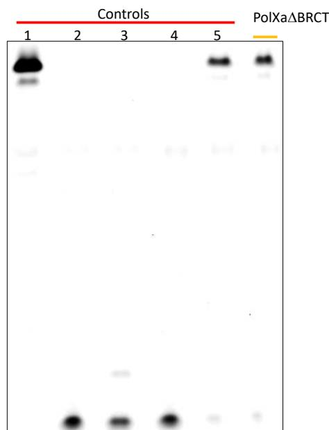
Figure 143 : Résultat du test d'activité dRP lyase de PolXa $\Delta$ BRCT. Contrôles : 1 : ADN initial non traité par les enzymes du kit USER3 ; 2 : ADN traité par les enzymes USER3 ; 3 : réaction sans ADN ligase ; 4 : réaction sans ADN polymérase ; 5 : contrôle positif réalisé avec l'ADN polymérase  $\beta$ .
