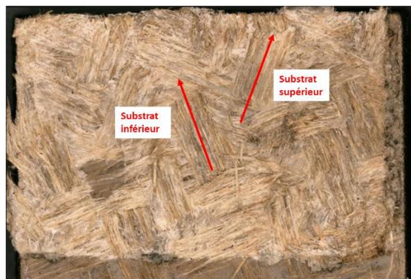
Figure VI.20 : Orientation des paquets de fibres (exemple ISO  $-22,5^\circ$ ).
