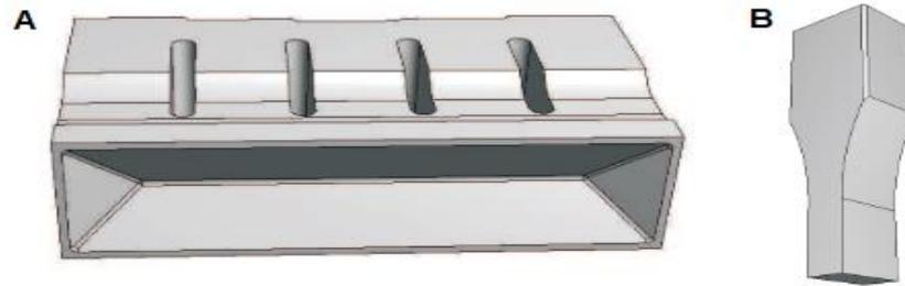
Figure I.9 : Formes de la sonotrode : a) Canon b) Sonats [27].
