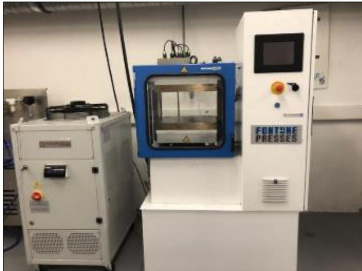
Figure II.2. Presse de thermocompression Fontijne Grotnes TPC 321.
