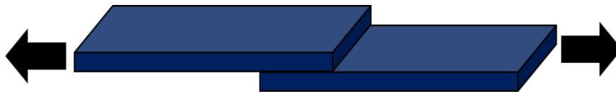
Figure I.26 : Schéma de la configuration Single-Lap Shear (SLS).
