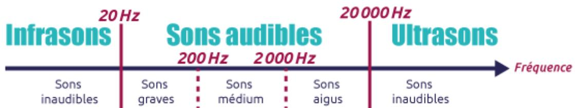
Figure I.5 : Ondes ultrasonores classés par plages de fréquence [22].
