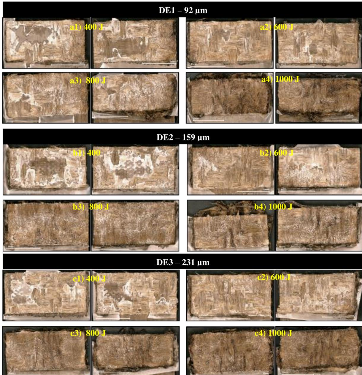
Figure A3.1 : Faciès de rupture des échantillons soudés avec et sans DE avec différentes énergies de soudage. a1- c1) 400 J, a2 – c2) 600 J, a3- c3) 800 J, a4 – c4) 1000 J.
