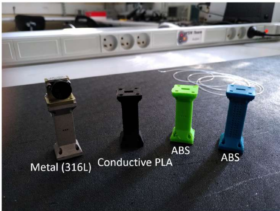
FIGURE 3.23 – Guides d'ondes imprimés avec la technologie additive.
