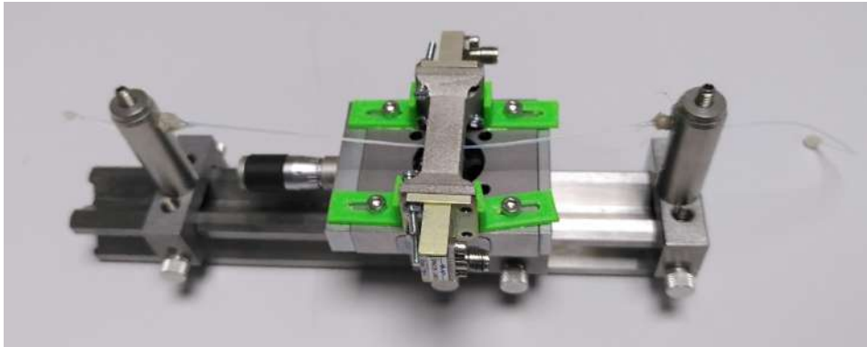
FIGURE 3.11 – Plateforme de micro-positionnement et son guide d'onde sous test.
