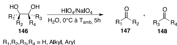
Schéma I-49 : Synthèse d'aldéhydes par clivage oxydant à partir d'un diol à l'acide périodique ou son sel de sodium par Malaprade et al.
