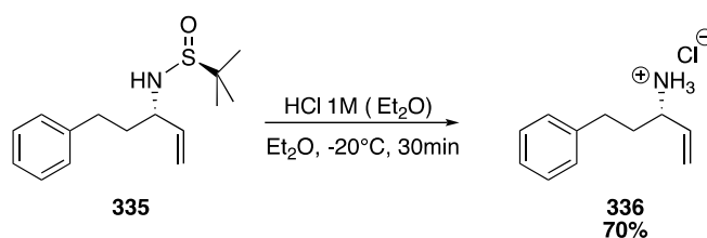
Schéma III-32 : Déprotection de la sulfinamide en présence \text{HCl} 1M dans l'éther
