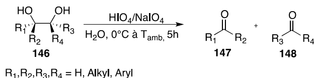
Schéma I-49 : Synthèse d'aldéhydes par clivage oxydant à partir d'un diol à l'acide périodique ou son sel de sodium par Malaprade et al.
