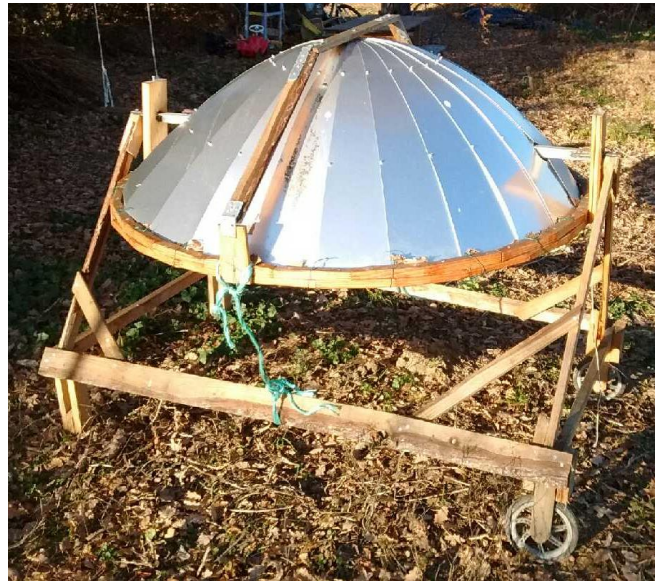
Figure III-2 : Photo de la parabole avec une structure en bois.
