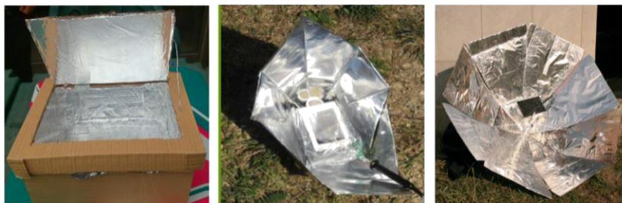
Figure I-62 : (Gauche) Concentrateur boîte, (Centre) concentrateur à panneaux et (Droite) concentrateur parabolique étudié par Mendoza et al. [156]
