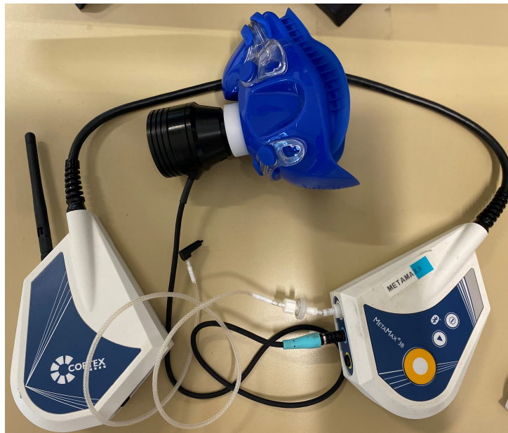
(b) Metamax 3B - Appareil de mesure, masque, capteur de débit d'air, sonde électrochimique.
