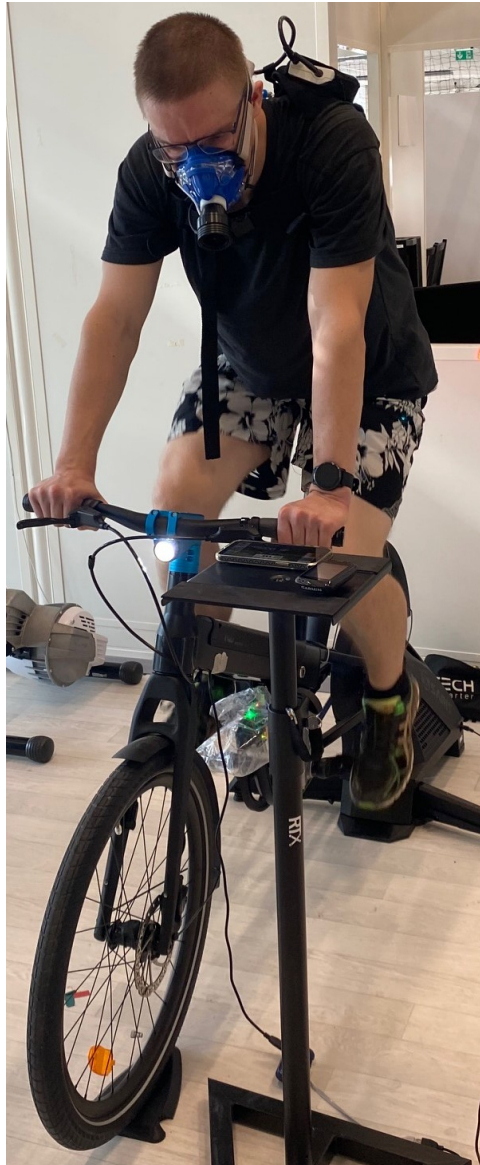
Image 1.8 – Personne avec un masque oronasal pour une mesure de VO_2 .
