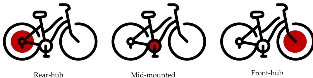
Image 2.7 – Différentes motorisations pour les vélos électriques.
