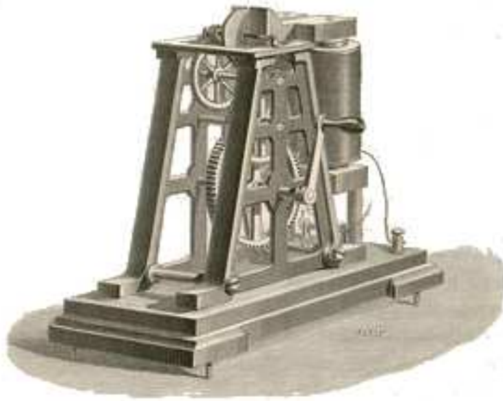
FIG. 3.1: Démonstrateur inventée par Léon Foucault afin de montrer l'action de l'induction magnétique [Fou78].
