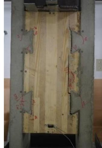
b. Mode de rupture des spécimens
