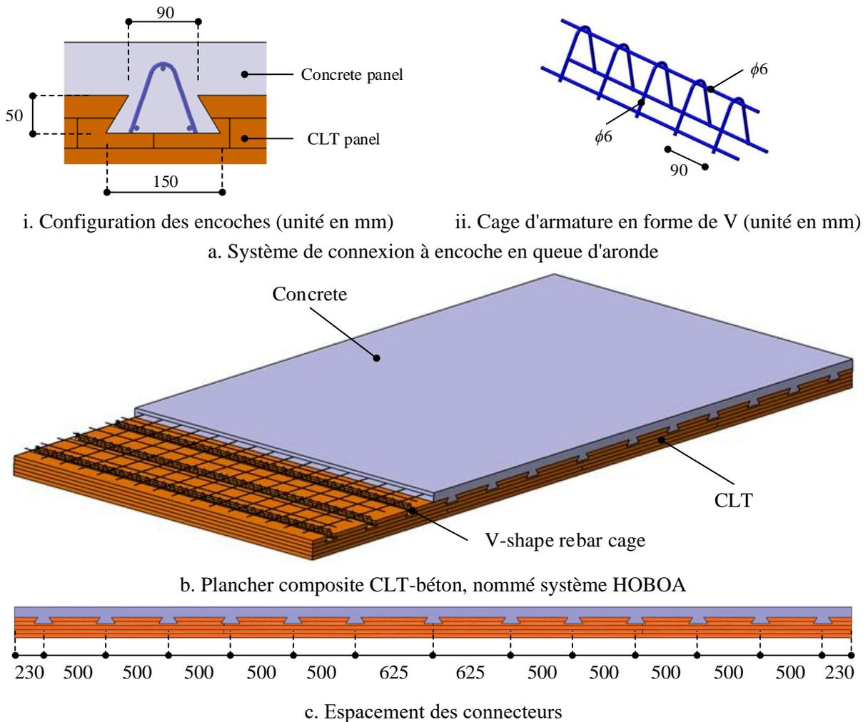
Figure 1: Plancher composite CLT-béton, nommé système HOBEO avec connexion par encoches.
