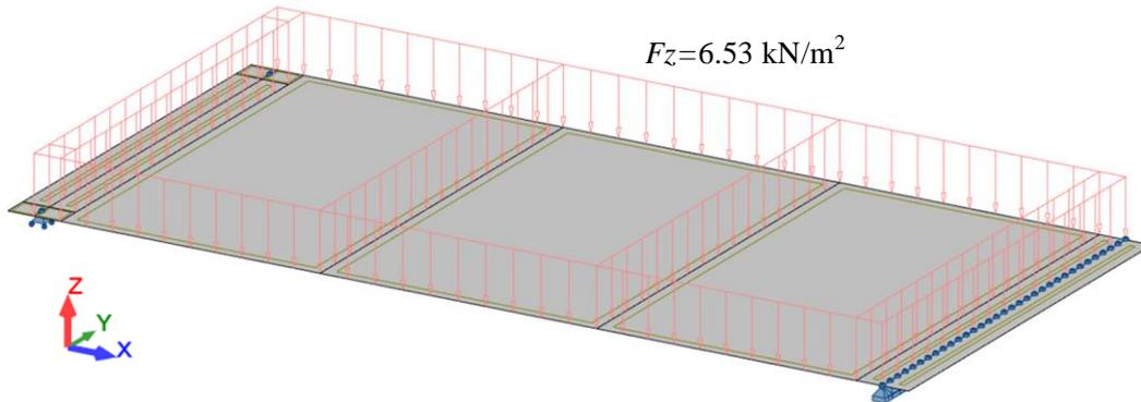
Figure 22: Configurations de chargement appliquées sur le modèle de plaque.
