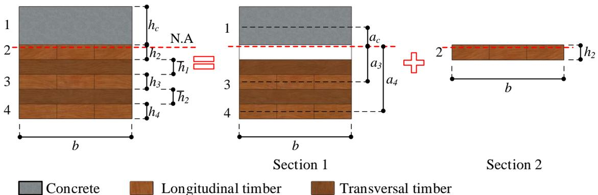
Figure 18: Calcul des dalles composites CLT-béton à 5 couches [36].
