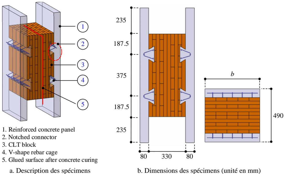
Figure 2: Description et dimensions des spécimens de pushout.
