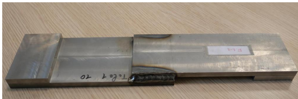
a. Eprouvette pour le test de traction après soudage
