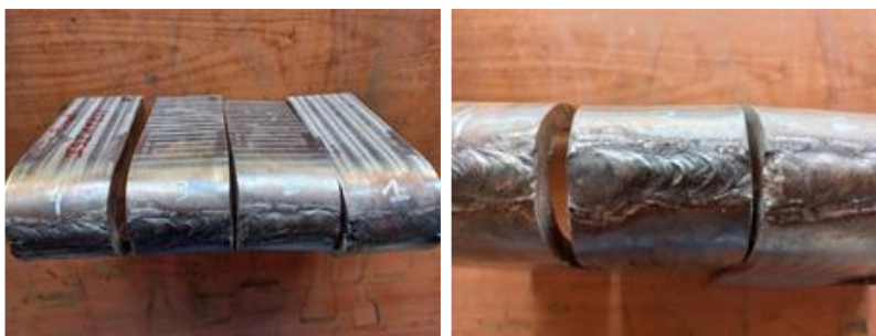
Figure I-8 : Vue des quatre éprouvettes pliées à 180° et zoom sur l'éprouvette 3
