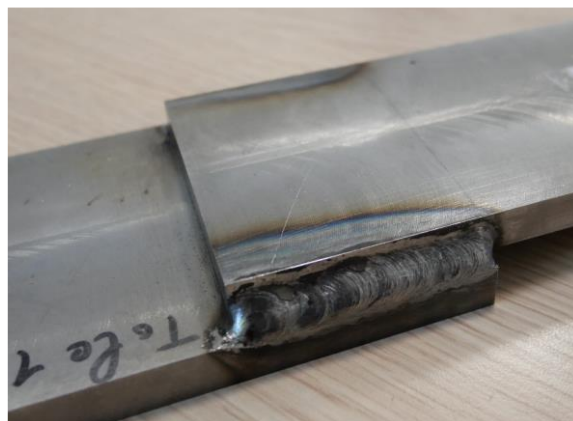
a. Eprouvette avant collage des jauges
