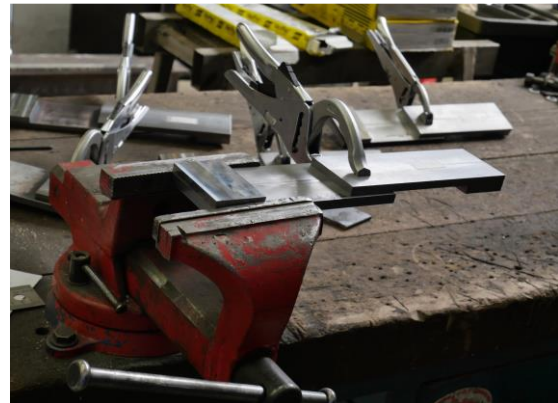
a. Préparation des éprouvettes pour le soudage b. Mise en position et bridage de l'éprouvette (éprouvettes retenues pour les tests de traction)
