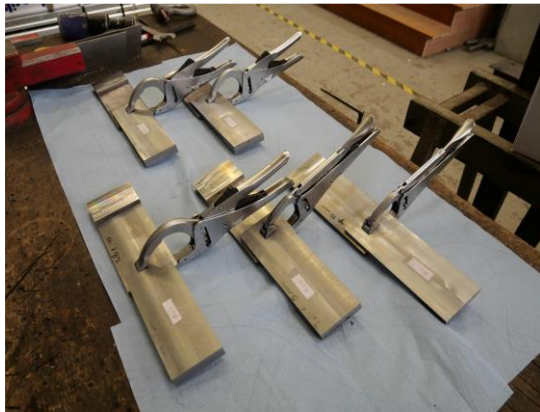
a. Préparation des éprouvettes pour le soudage b. Mise en position et bridage de l'éprouvette (éprouvettes retenues pour les tests de traction)
