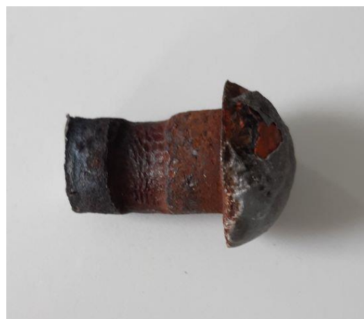
b. Rivets endommagés
