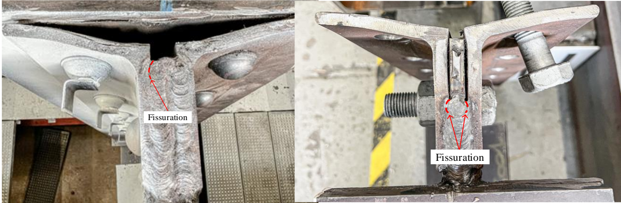
g) Fissuration soudure d'AR-S-2
