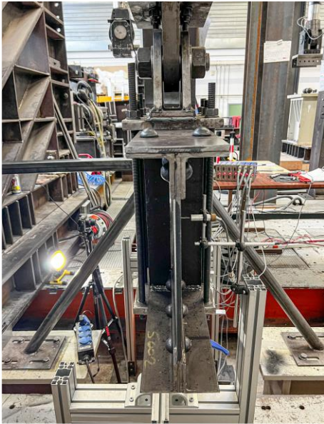
a) Déversement de la poutre d'AR-S-2
