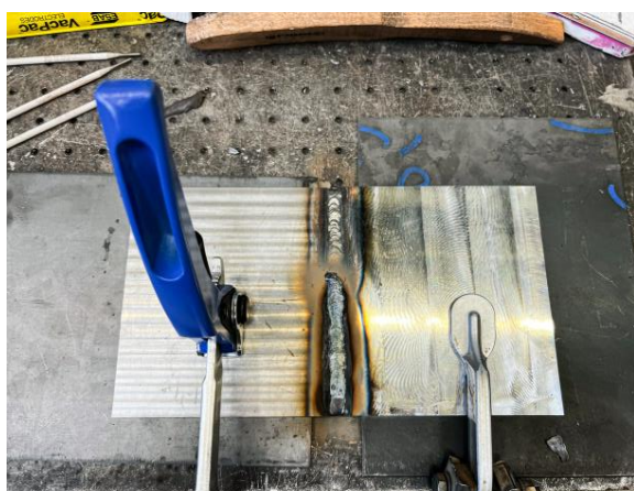
a. Éprouvette après dépôt de la 2 ème baguette
