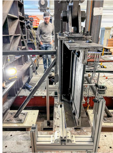
b) Déversement de la poutre d'AB-S-1
