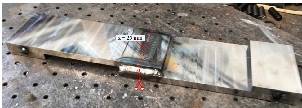
b. Eprouvette retenue pour la mesure des contraintes résiduelles
