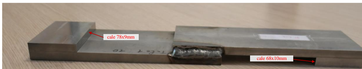
Figure I-35 : Mise en place de cales sur l'éprouvette
