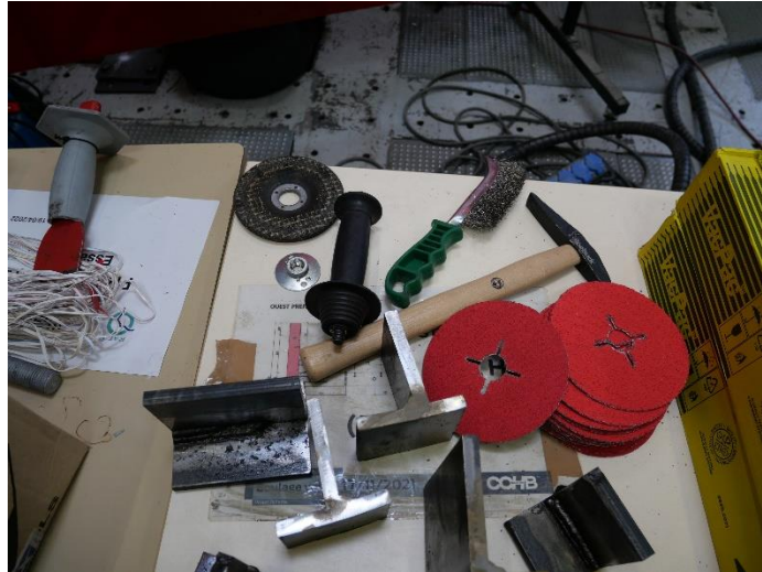
Figure III-8 : Equipement pour parachèvement du spécimen avant et en cours de soudage
