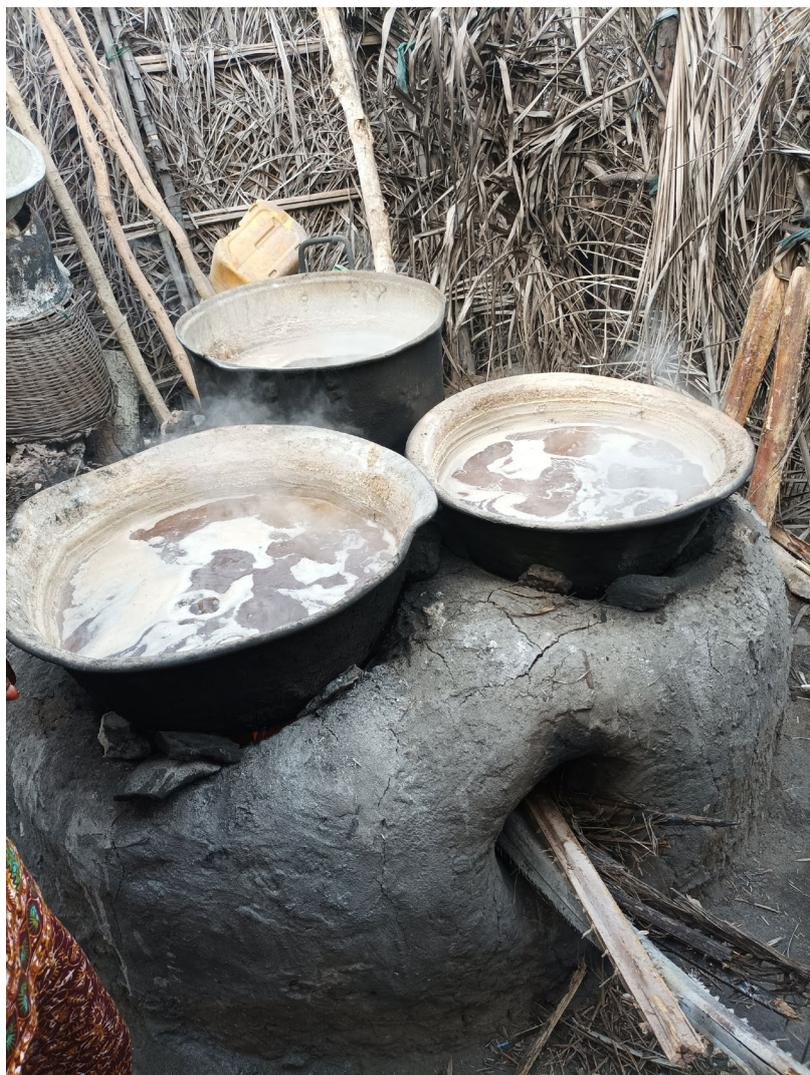
Figure 15 : Four traditionnel permettant la production de sel par évaporation au Bénin. Mars 2022.
