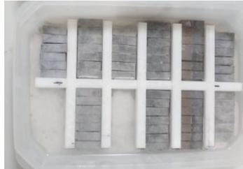
Figure 35 Échantillons conservés dans un bain d'eau saturée en chaux pendant la période d'hydratation
