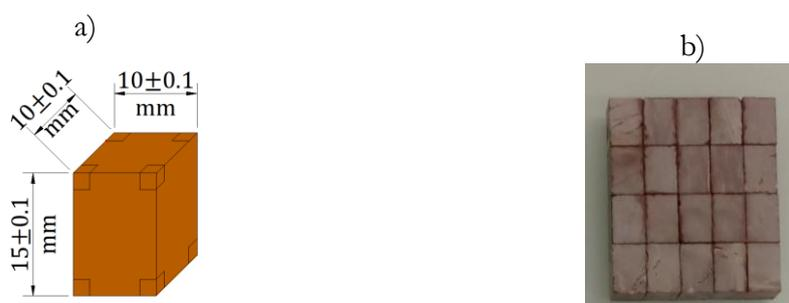
Figure 31 Dimensions du granulat (a) et lot de 20 granulats après la découpe (b)
