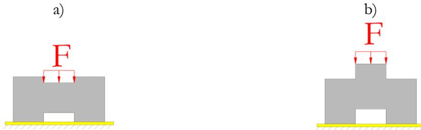
Figure 70 Configuration de l'essai sur échantillon en forme de H (a) et de Y inversé (b)
