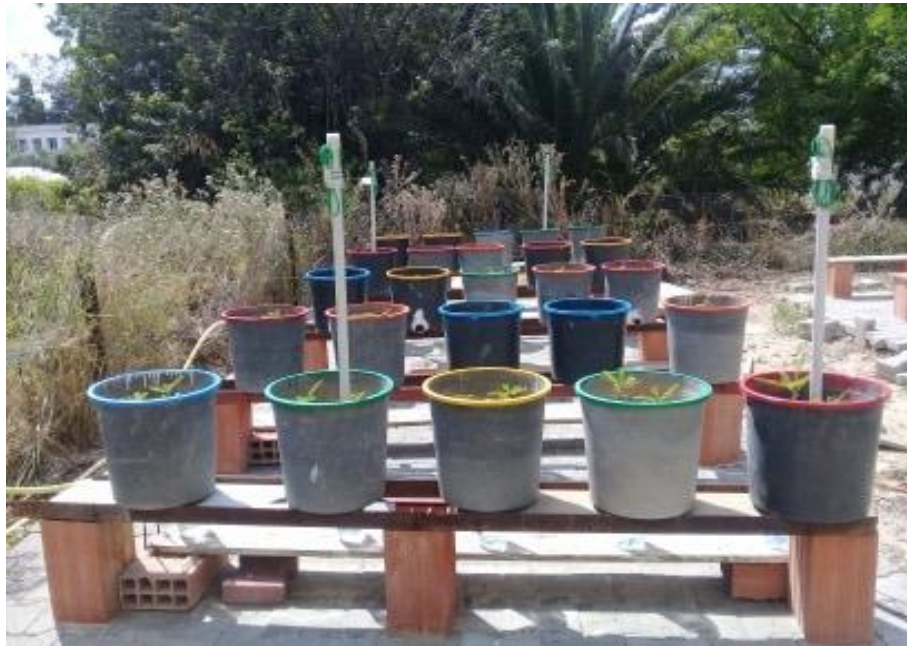
Figure 2.9 : Implantation des tensiomètres watermark dans les pots.
