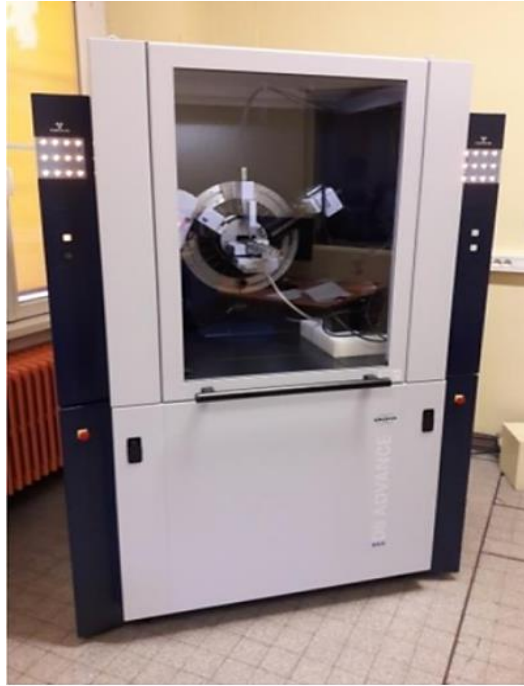
Figure 2.6 : Diffractomètre D8 Advance Eco.
