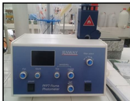
Photo 2 : Spectrophotomètre de flammes (Jenway, PFP7, France).
