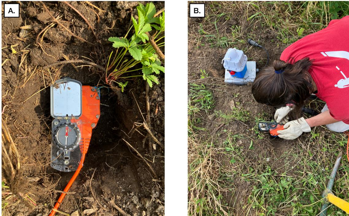
FIGURE 6.5 – Installation de capteurs, exemple de (A) la station LC02 et (B) la station LC03. Les capteurs sont enterrés, horizontalisés et orientés vers le nord grâce à une boussole.
