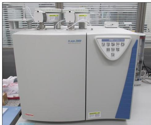
Figure IV. 4: Analyseur élémentaire CHNS-O Flash 2000
