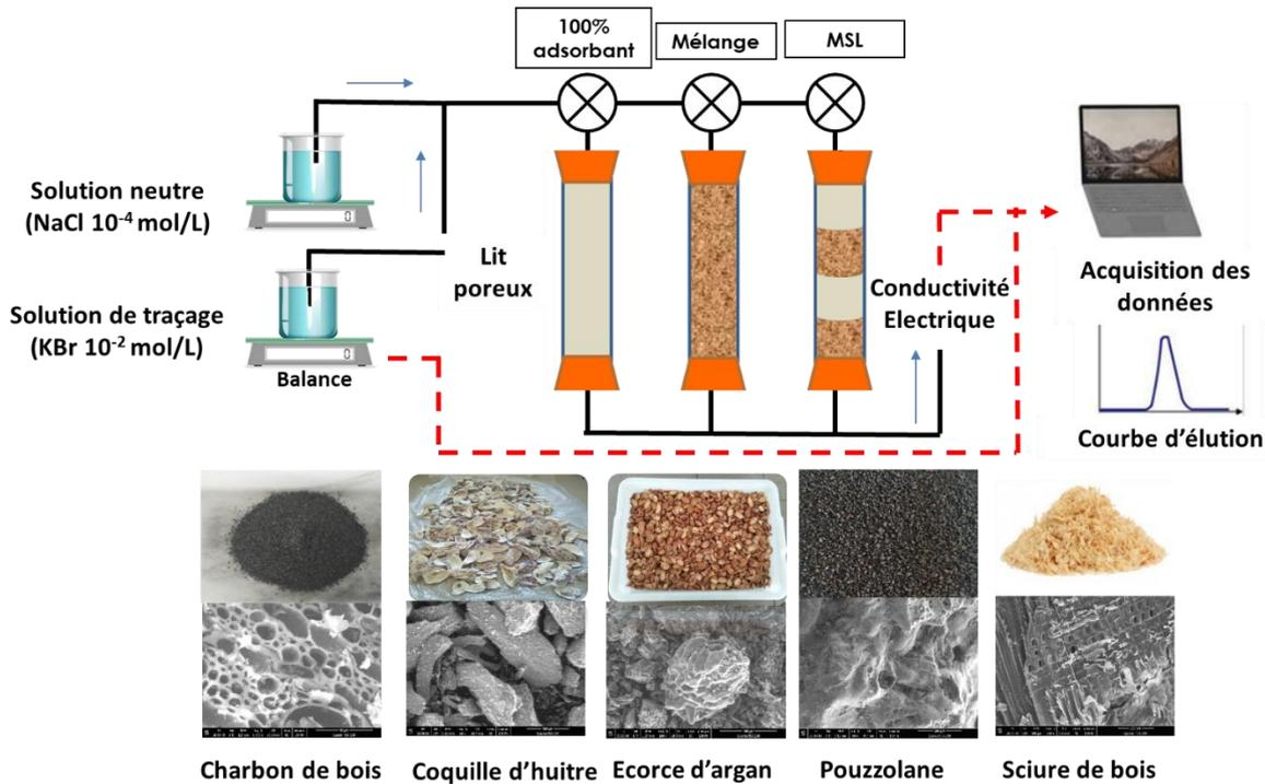
Figure III. 1: Dispositif expérimental du test de traçage
