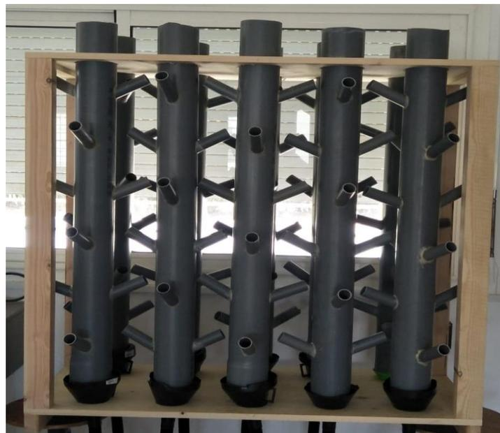
Figure II. 7: Colonnes expérimentales d'infiltration-percolation
