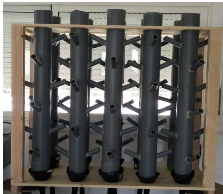
Figure II. 7: Colonnes expérimentales d'infiltration-percolation
