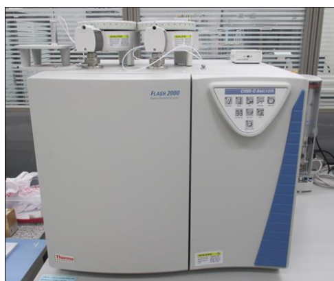
Figure IV. 4: Analyseur élémentaire CHNS-O Flash 2000
