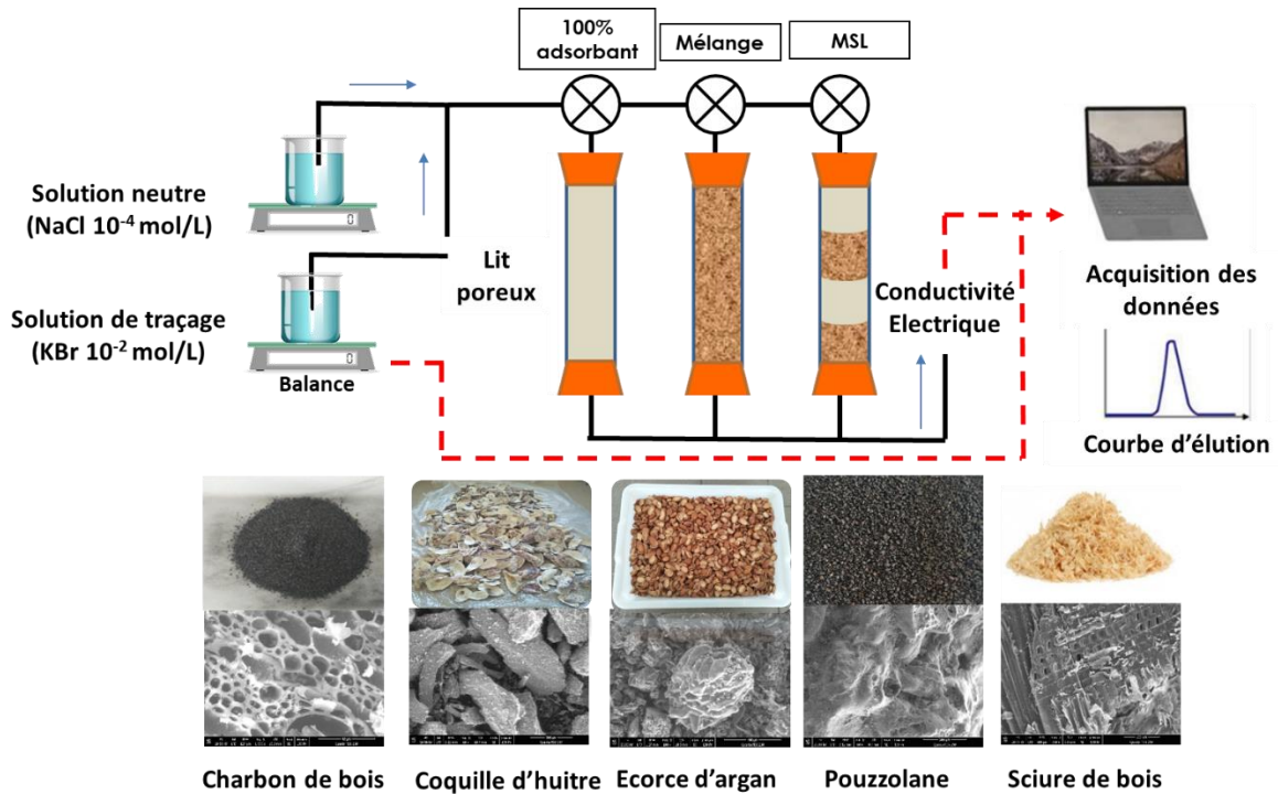
Figure III. 1: Dispositif expérimental du test de traçage
