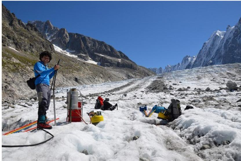
FIGURE II.8 – Implantation d’une balise à l’aide d’une sonde à vapeur - Argentière 2015. Source : VINCENT et al. [2007]
