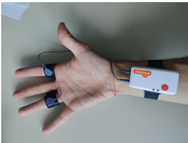
FIGURE 4.3 – Vue d’ensemble du matériel utilisé pour la mesure de l’AED : électrodes avec câble, boîtier Bluetooth
