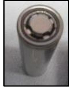
Figure 58 : ESSAI 2 - Photographie d'une cellule LGHG2 possédant 4 orifices d'évacuation
