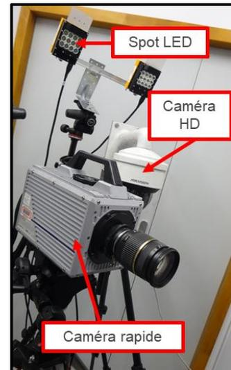
Figure 72 : ESSAI 3 - Photographie des instruments de prise de vue (caméra rapide, HD et spot LED) pour imager l'emballement thermique
