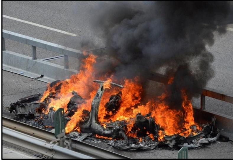
Figure 3 : Voiture électrique (Tesla) totalement brûlée, suite à un accident sur une autoroute Suisse provoquant une défaillance de la batterie au lithium-ion - tiré de [6]
