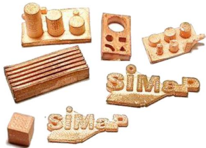
Figure 1-24 : Exemple de pièces fabriquées par PAM dans les travaux de Singh et al.[77]
