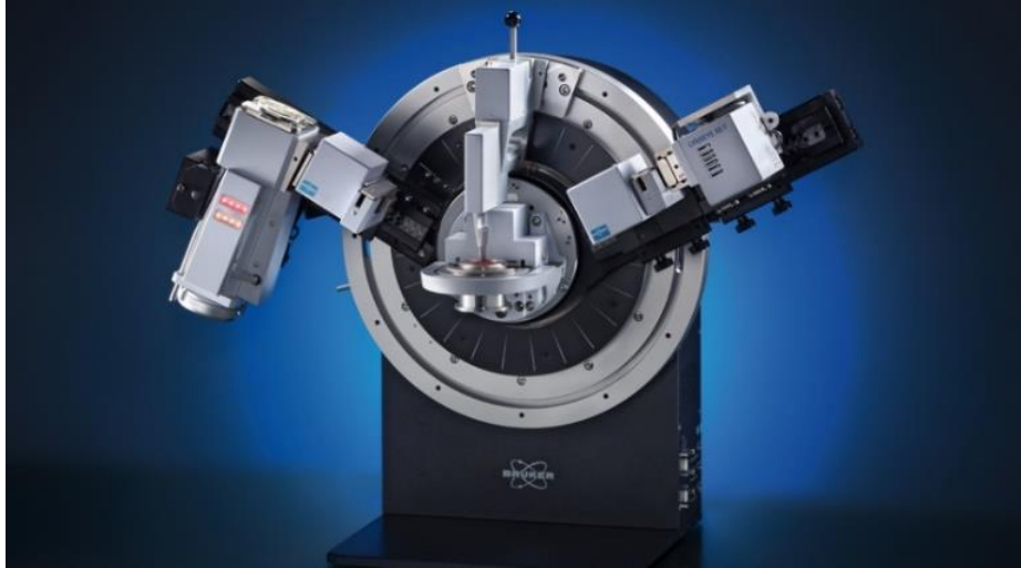
Figure 2-15 : Photo du montage expérimental du diffractomètre pour l'analyse par diffraction de rayons X sur poudre
