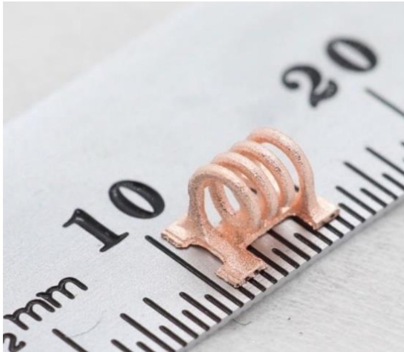
Figure 1-28 : Exemple de pièce (dissipateur thermique) fabriquée par l'entreprise Holo après des traitements thermiques de déliantage et frittage [97]
