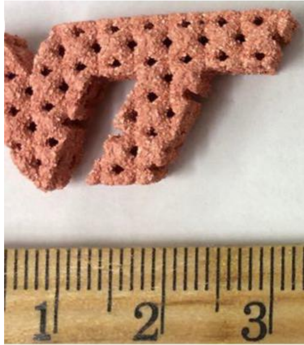
Figure 1-19 : Exemple structure creuse réalisée en cuivre par Binder Jetting [71]
