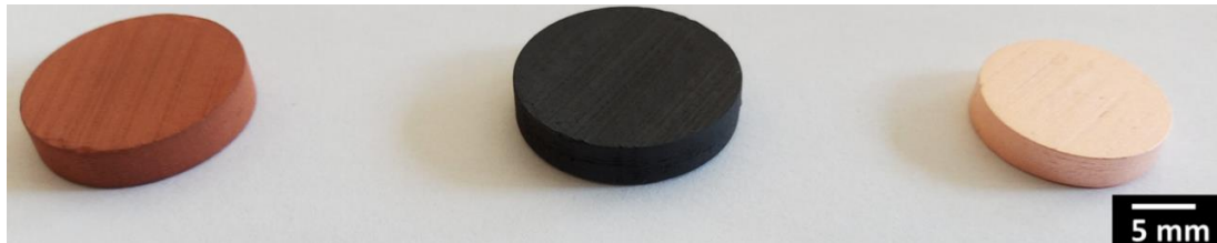
Figure 5-13 : Aspect visuel d'une pastille après impression (à gauche), après déliantage avec le cycle DEL1 (au milieu) et après déliantage avec le cycle DEL1 et frittage avec le cycle FRITT1 (à droite)
