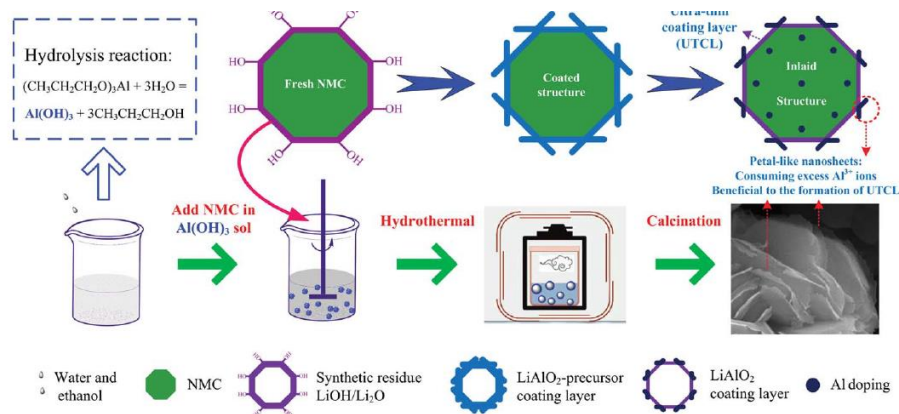
Figure 39 : Méthode de recouvrement par voie hydrothermale employée par Li et al. 103
