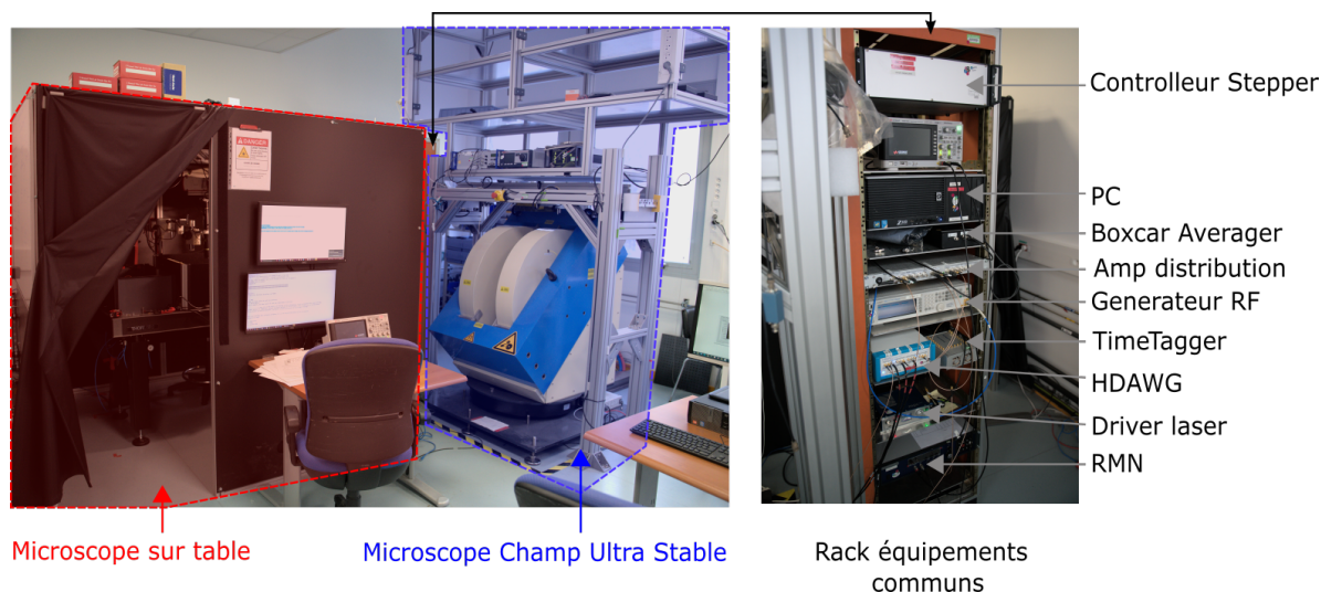
Figure 50: Positionnement des deux systèmes de microscopie à centre NV : le premier est installé dans une chambre noire sur une table optique, tandis que le second, destiné à l'utilisation sous champ ultra-stable, est placé dans l'entrefer d'un électro-aimant. Plusieurs composants/équipements sont partagés entre les deux microscopes.
