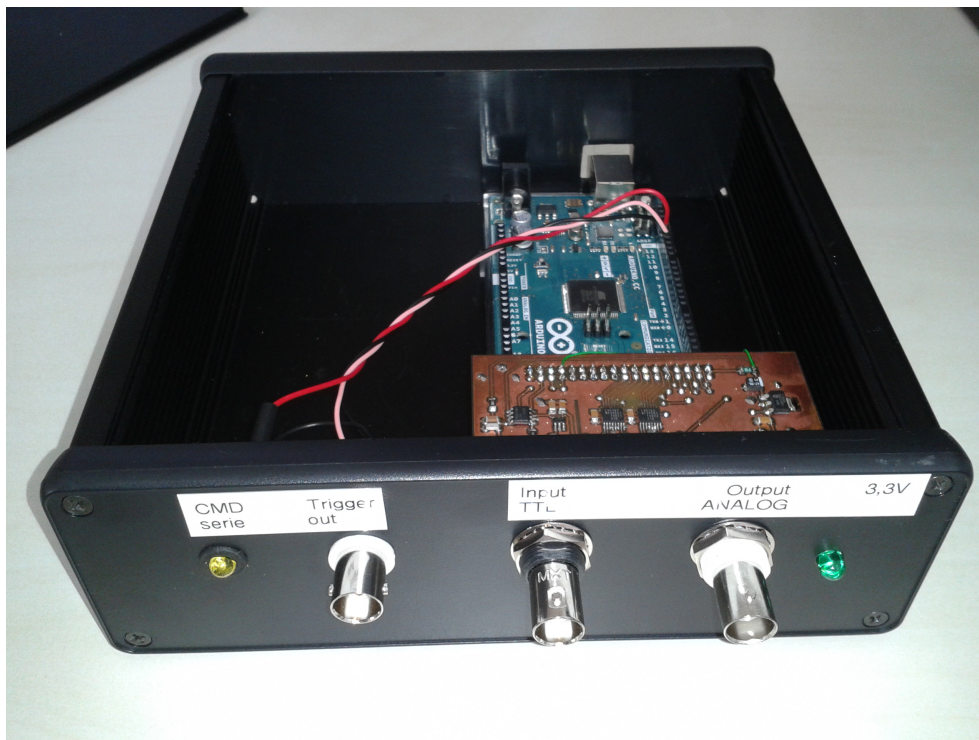
Figure 66: Implémentation matériel du boxcar averager, on observe la simplicité de mise en oeuvre via l'utilisation d'une carte Arduino méga.
