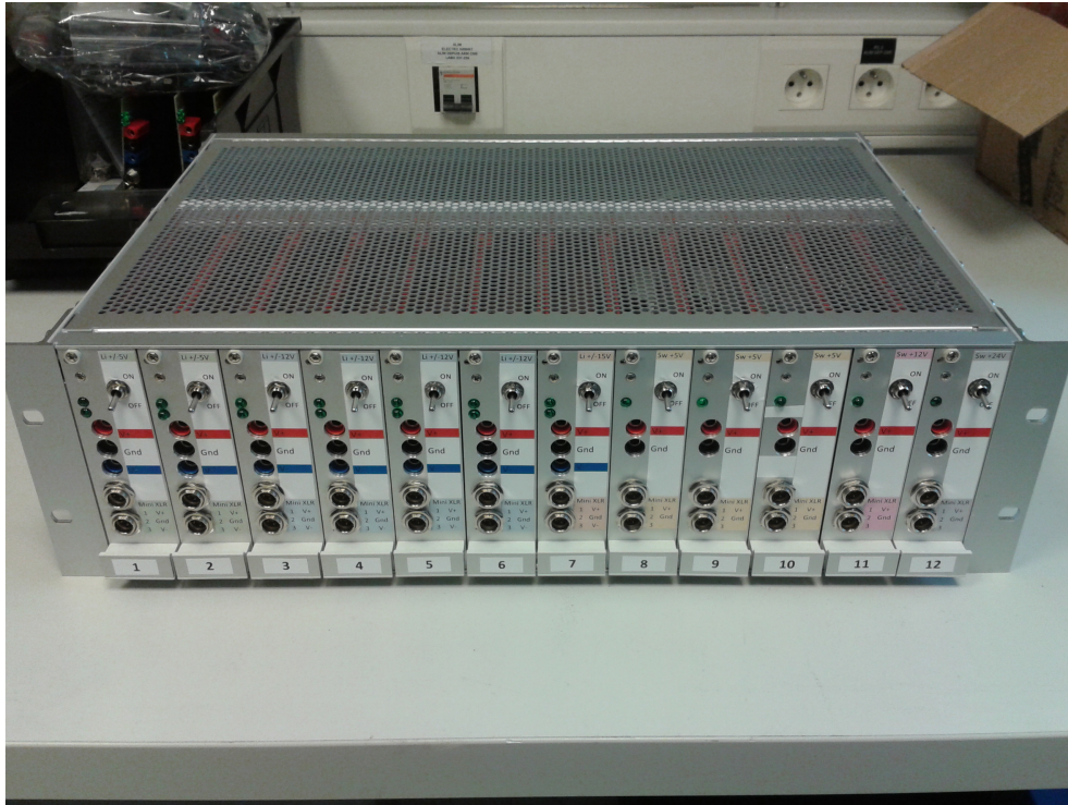
Figure 67: Rack d'alimentations multirails sur mesure contrôlable par ordinateur
