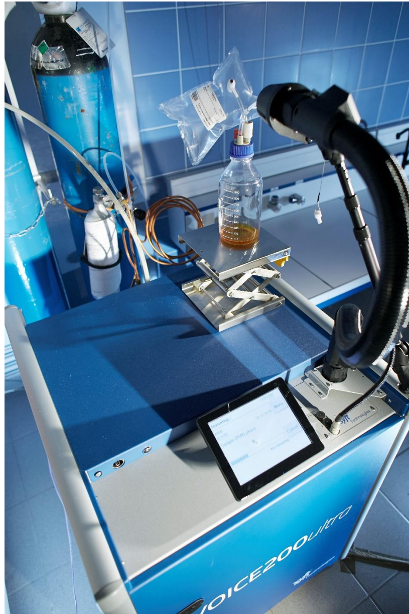
Figure 54 : Spectromètre de masse de type SIFT-MS utilisé dans le cadre d'une collaboration avec le laboratoire IPREM de l'Université de Pau et des pays de l'Adour, dans le but de mesurer la quantité de métabolites bactériens.
