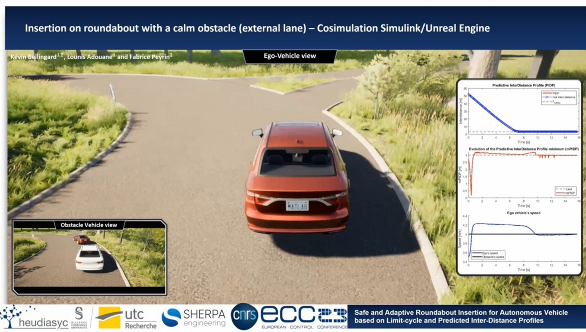
FIGURE 5.5 – Scénario du VA devant s'insérer dans un rond-point comportant un VO dynamiques. L'image principale (au centre) représente le VA. Sur la gauche, est représentée, la vue depuis le VO. Sur la droite, de haut en bas, l'évolution de la PIDP, l'évolution du minimum de PIDP avec la distance de sûreté à respecter et enfin les vitesses des véhicules (Figures extraites de cette vidéo : https://www.youtube.com/watch?v=fe7JPjua4Ac )
