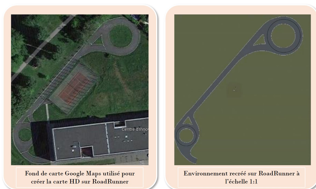
FIGURE 5.8 – Création de la plate-forme Seville sur RoadRunner à partir d'un fond de carte Google Maps afin d'en générer la carte HD et de l'utiliser pour la navigation du VR
