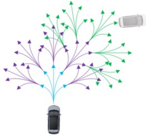
FIGURE 2.13 – Méthode d'exploration rapide d'arbres de décision (RRT)
