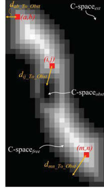
(b) Représentation de l'environnement en cellules. Les plus blanches représentent les cellules les plus sûres
