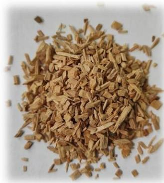
Figure 2.1 : biomasse entrante, copeaux de bois de hêtre
