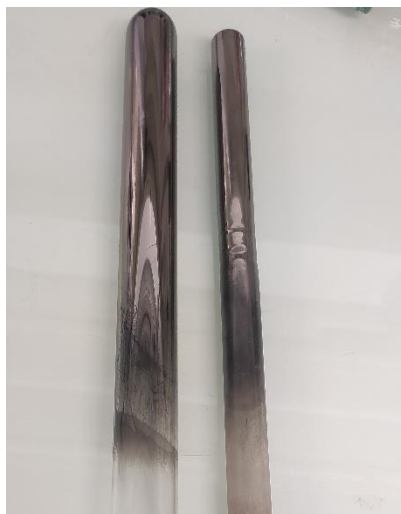
Figure 4.2 : Dépôt des suies sur la paroi du réacteur après le craquage thermique à 900 °C
