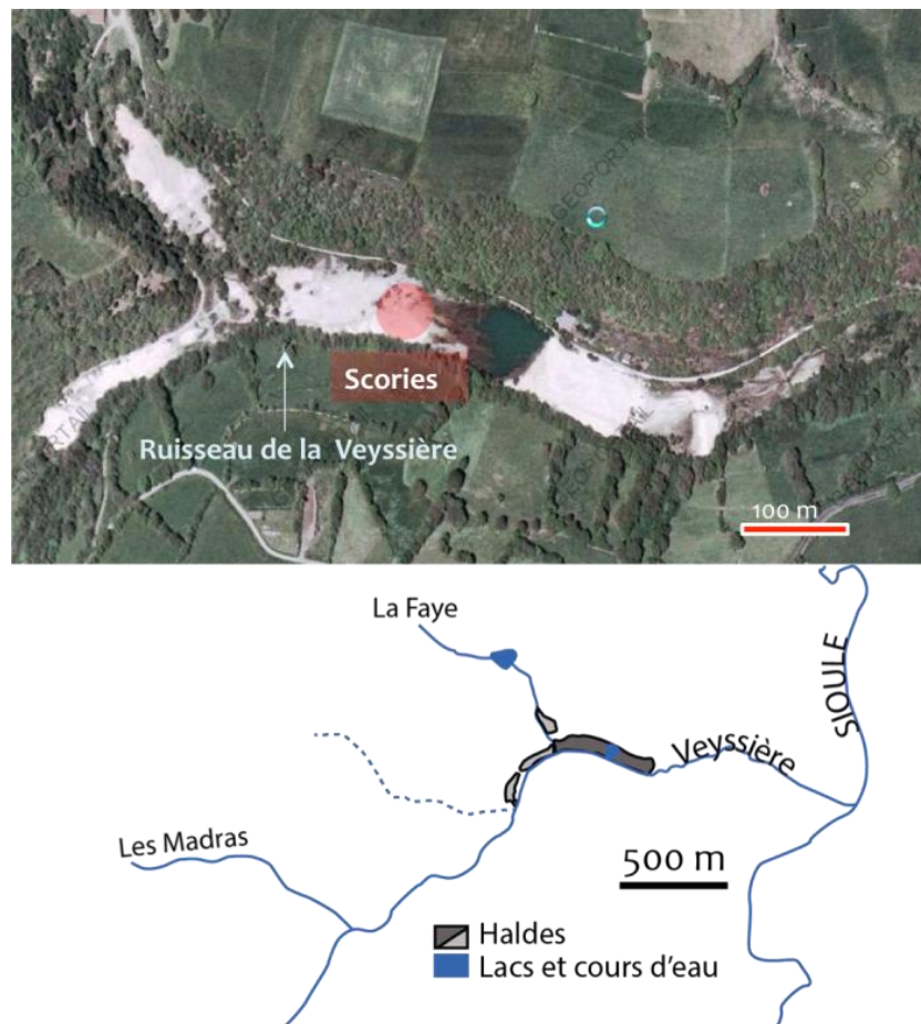
Figure 13 : Photo aérienne du site des Rosiers-Roure (photo IGN, CRAIG, eurogeographics) et schéma de la répartition des stériles miniers (les Rosiers, gris clair – Roure, gris foncé) et du réseau hydrographique de la Veyssière jusqu'à sa confluence avec la Sioule.
