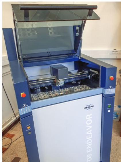
FIGURE 2.7 – Photographie du diffractomètre D8 Endeavor de l'institut Néel. La chambre de mesure est masquée derrière la plaque métallique.
