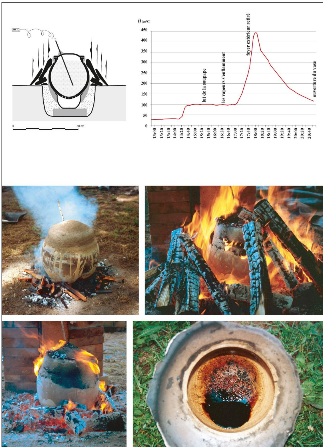
III. II- 116 : expérimentation de distillation per descensum d'écorce de bouleau, selon la technique du double-pot avec lutage des céramiques, au Bas Moyen Age en Ile-de-France (Thomas et Claude 2011, fig. 16 : schéma, courbe de température et photographies de l'opération en cours et résultat final ; photos : N. Thomas, Inrap).
