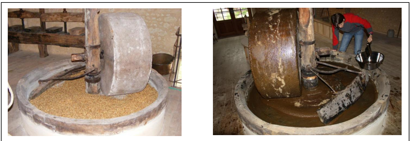
Ill. III- 153 : moulin à huile de noix du Moulin de Narrat en Charente-Maritime ( http://www.moulindenarrat.fr/La-Farine-l-Huile-de-Noix-1.htm ). Concassage des noix à la meule en pierre (photo 1) et broyage après 6h30 de meule (photo 2).
