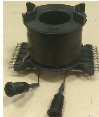
(b) Inductance à air réalisée permettant de diminuer les capacités parasites
